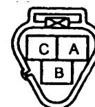
CONECTOR LADO CABLEO (VISTO DEL LADO TERMINALES)
